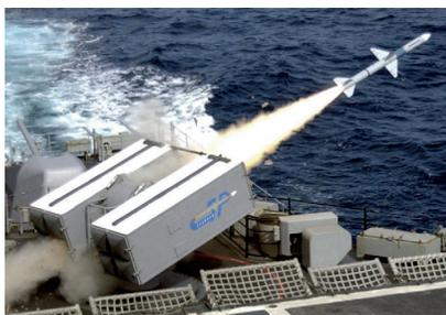
Пусковая установка Mk.29 Sea Sparrow на борту USS Fife (DD 991)
