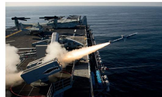
Пусковая установка Mk.29 Sea Sparrow на борту USS Fife (DD 991)
